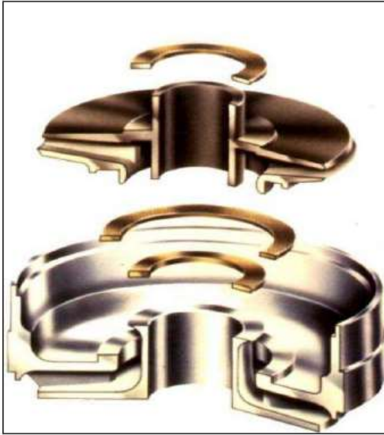
Figura 2.10. Impulsor y Difusor. Recuperado de (Holger Maroto, 2012)
