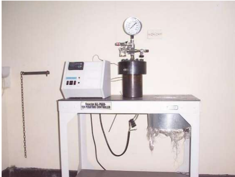
Ilustración 14 - Reactor de presión Parr 4860. Tomado de: Ortiz, 2004.
