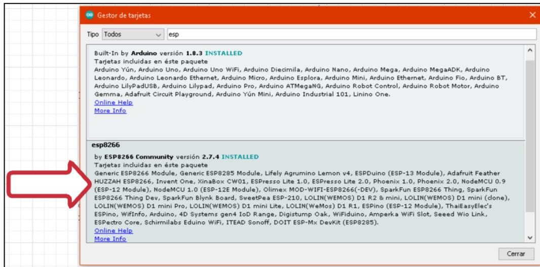
Figura 19 Visualización de la tarjeta ESP8266: Programa de Arduino
