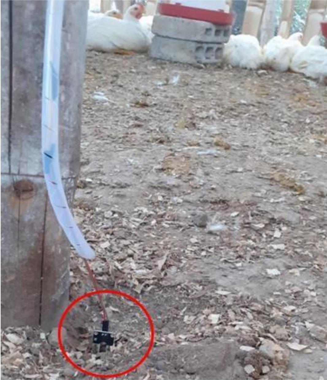
*Figura 104 Instalación de sensor humedad del suelo: Elaborado por el autor*
