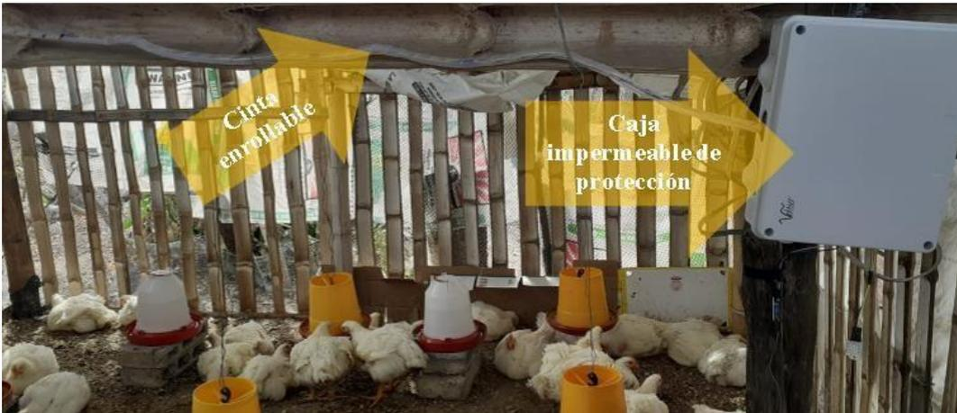
Figura 103 Protección de cables en cinta enrollable y caja impermeable para el circuito: Elaborado por el autor
