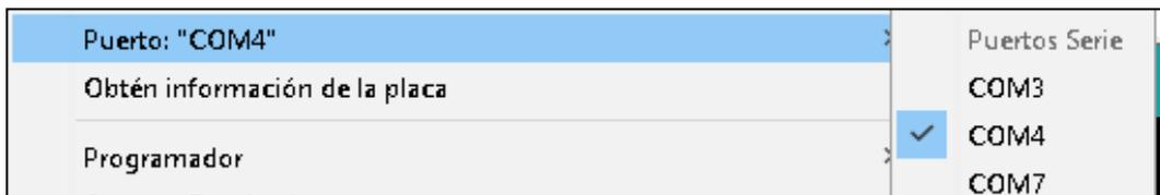
Figura 21 Visualización de puerto COM4 de la placa: Programa de Arduino
