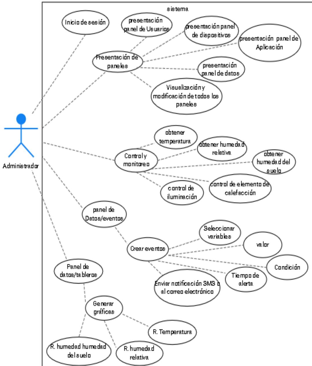
Figura 8 Diagrama caso de uso general de la plataforma: Elaborado por el autor
