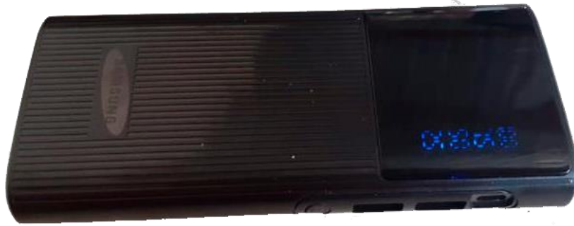
Figura 15 Batería de 5v con salida de 1 Amperio y 2 Amperio
