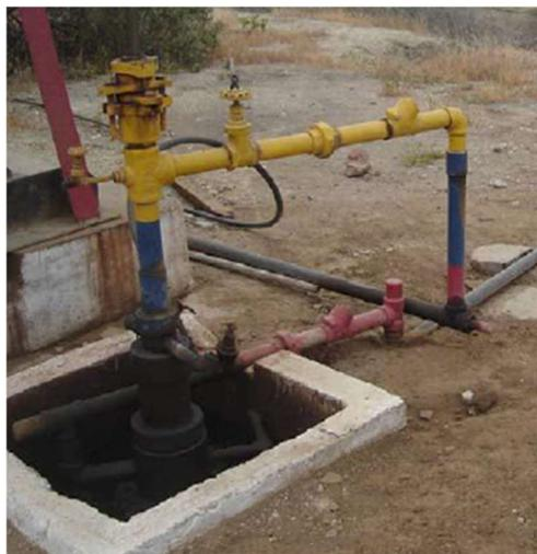
*Figura 4 Cabezal del pozo del campo Ancón (Pacifpetrol, 2018)*
