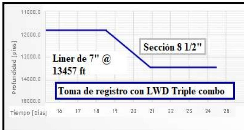
Figura 20: Curva de construcción del pozo sección 8 1/2”
