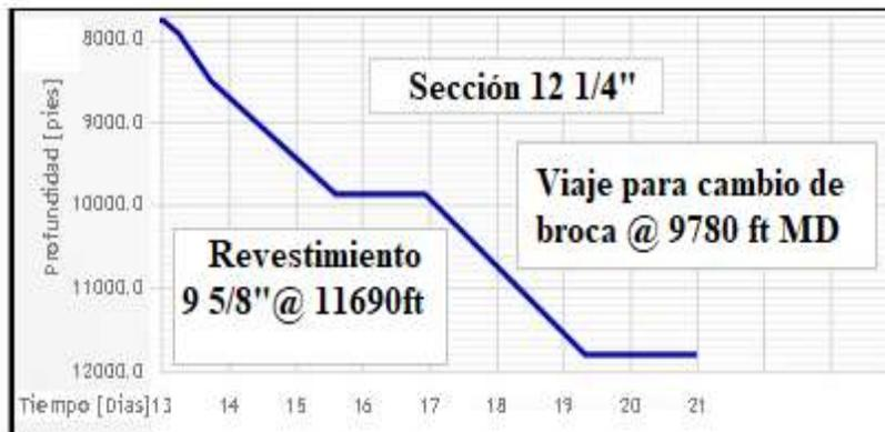
Figura 19: Curva de construcción del pozo sección 12 1/4”
