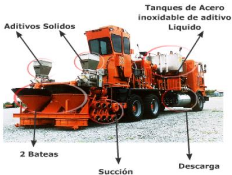
Figura 9 Partes de un mezclador o blender. Fuente: https://www.portaldelpetroleo.com/
