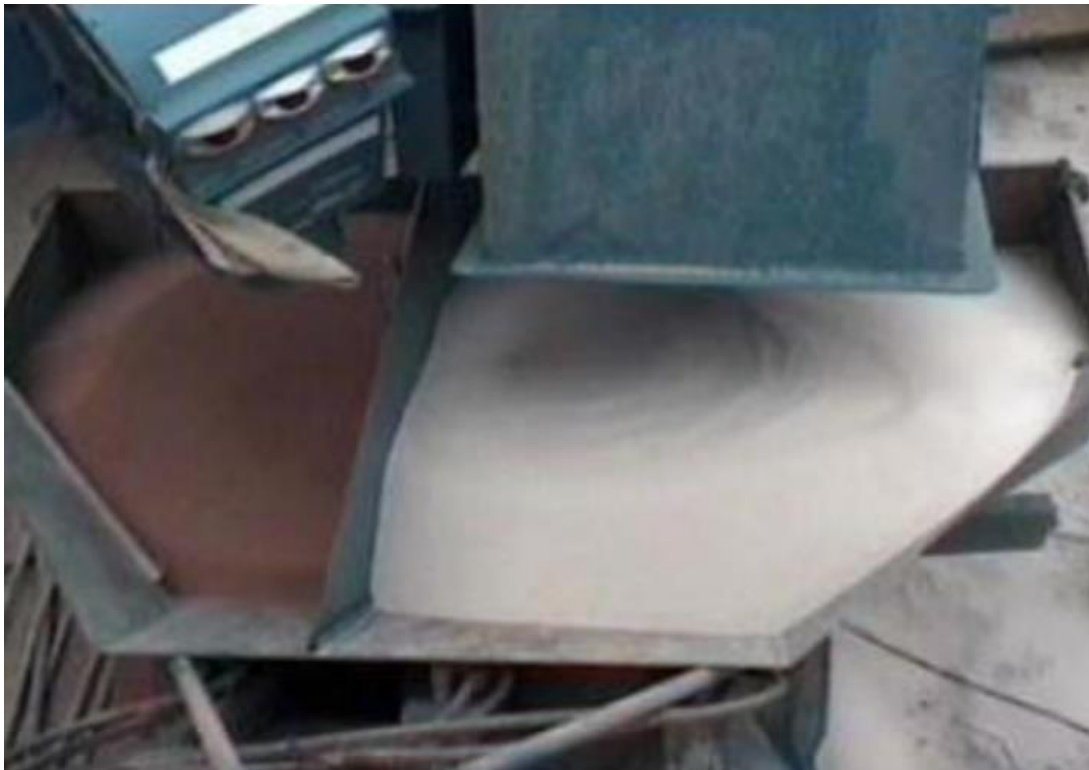
Figura 12 Batea para la mezcla de aditivos de fracturamiento. Fuente: Castañeda, 2007
