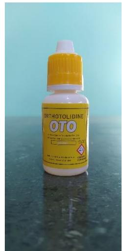
Análisis mediante colocación de indicador de cloro que contiene el agua
