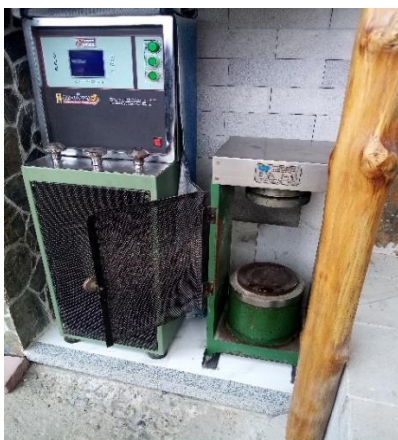
Figura 20 Prensa hidráulica, ensayos de resistencia a compresión.
