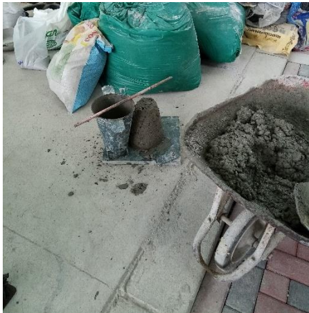
Figura 17 Ensayo de cono de Abrams
