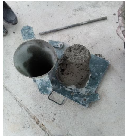
Figura 18 Ensayo para medir asentamiento
