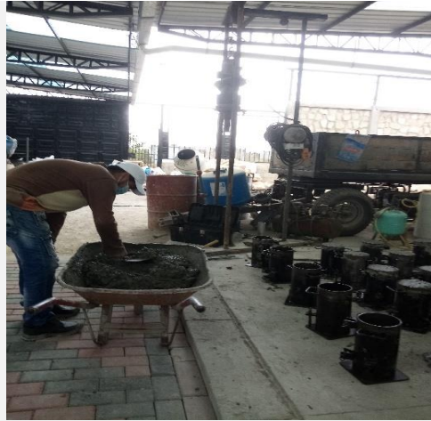
Figura 9 Mezcla y probetas para el hormigón.
