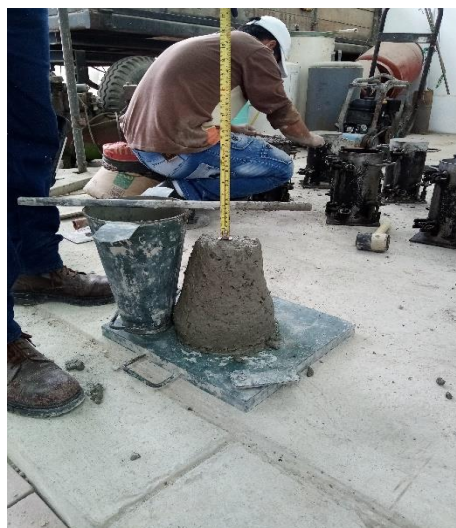
Figura 19: Medición de Revenimiento en el hormigón diseñado.
