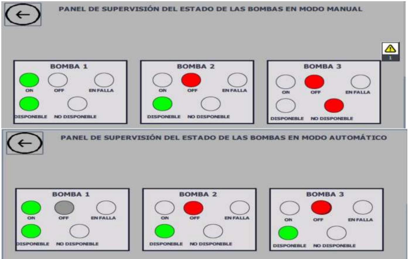
**Figura 17. Pantallas de supervisión del estado de las bombas en modo manual y automático.**
