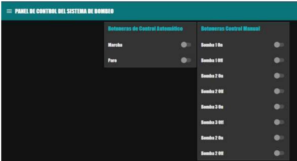
**Figura 25. Panel de control del sistema de bombeo en sistema SCADA**
