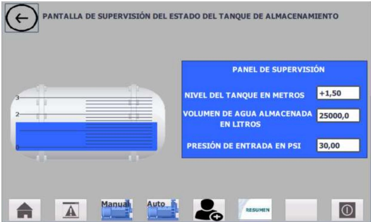
**Figura 15. Pantalla de supervisión del nivel del tanque**
