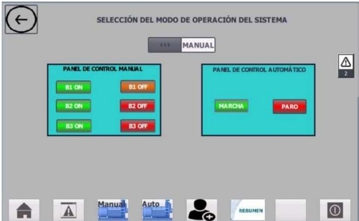
**Figura 14. Pantalla de selección del modo de operación del sistema**
