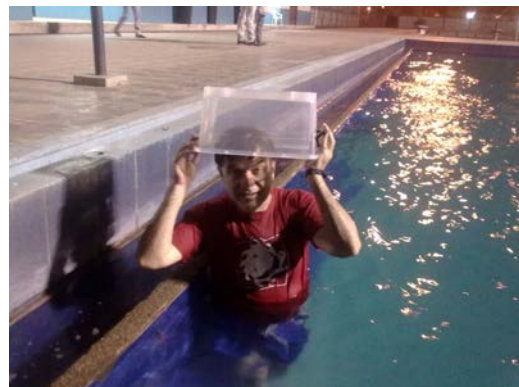
Fig.2 Prueba de respiración bajo el agua en campana de aire, momento antes de sumergirse. Otra persona tuvo que empujar desde el exterior hacia abajo para contrarrestar el empuje ascendente de la burbuja de aire creada.
