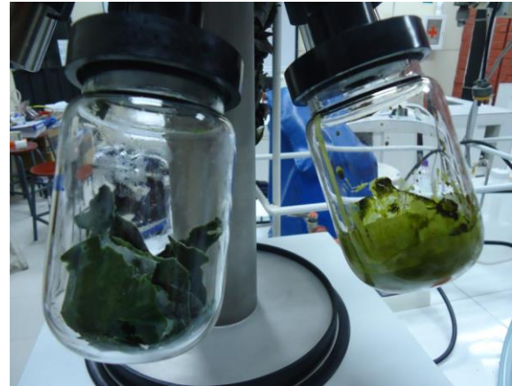
Figura 3. Liofilización de las muestras: Scenedesmus (izquierda) y Chlorella vulgaris (derecha). Fuente: Autoría propia.
