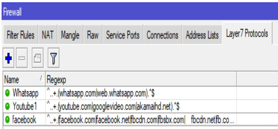
Figura 15 IP – Firewall – Creación Layer 7 Protocols
