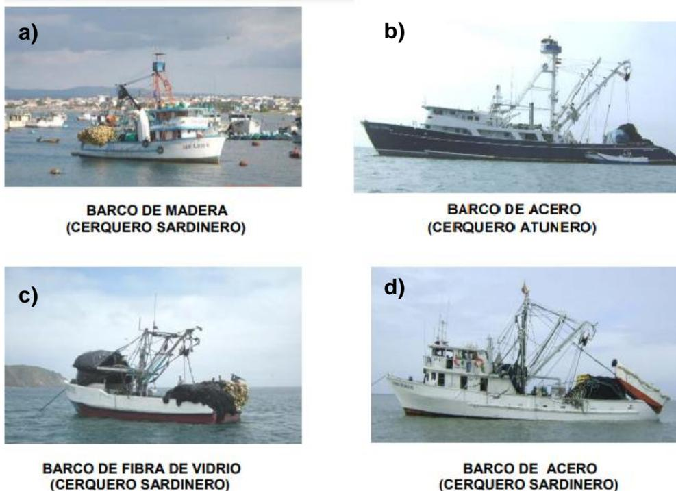
Figura 2. Tipos de embarcaciones que emplean red de cerco. a) Barco de madera, b) Barco de acero - atunero, c) Barco de fibra de vidrio, d) Barco de acero – sardinero.
