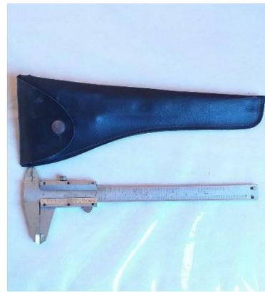
**Figura 15** Calibrador de vernier.
