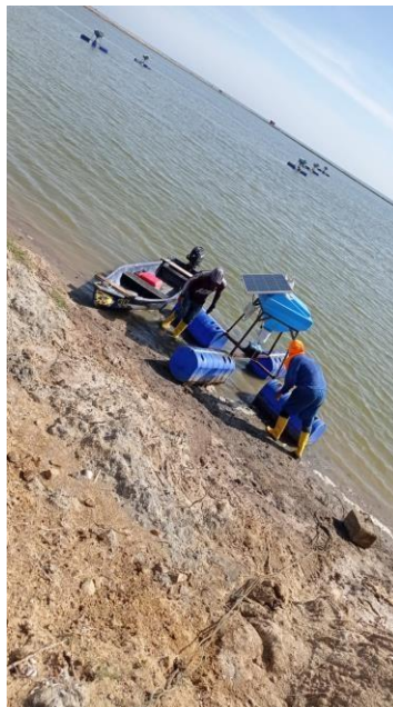
Anexo 7. Limpieza y revisión física de los equipos de alimentación automática de la piscina 72. Fuente: GRAMILESA S.A, 2021
