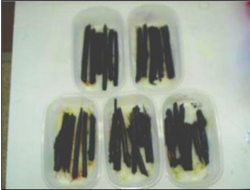
Foto 17: Instalación de primeras cámaras húmedas.
