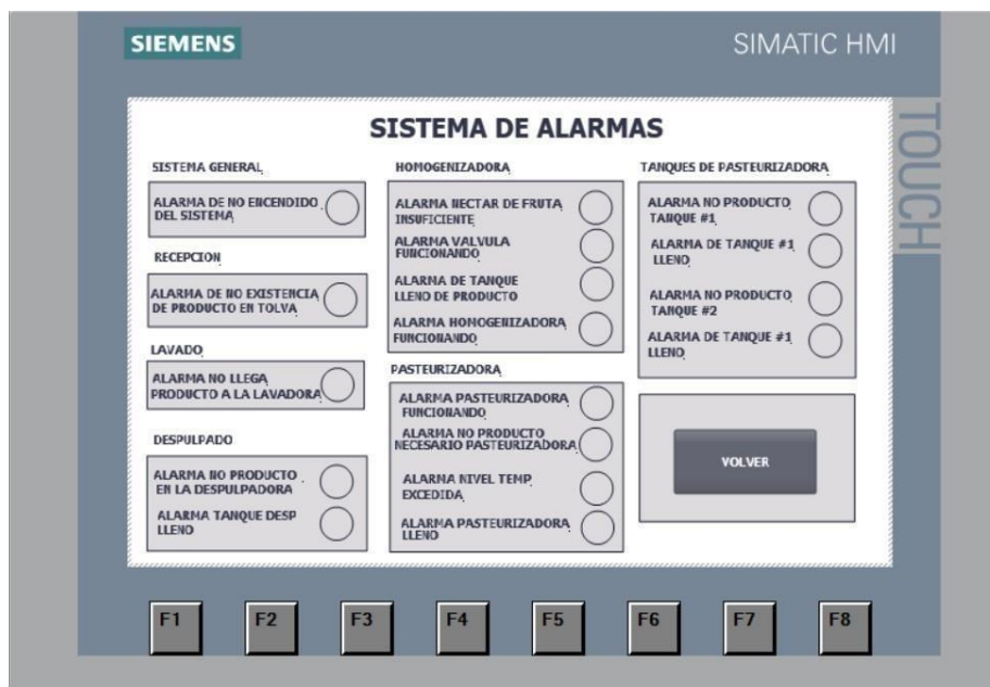
Figura 40. Sistema de alarmas
