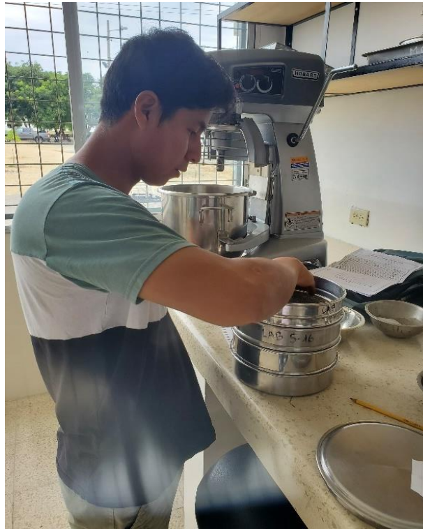
Ensayo granulométrico del agregado fino de los aluviales del Rio San Pablo (provincia de los Ríos) y rio Zapotal (Provincia Santa Elena)
