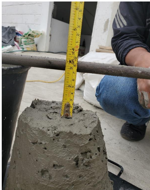
Ensayo de revenimiento a cada material de estudio (modelo patrón, aluviales del rio San Pablo y Zapotal)
