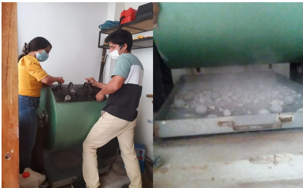
Ensayo de Abrasión de los Ángeles para los materiales proveniente de los aluviales del Rio San Pablo y Zapotal.
