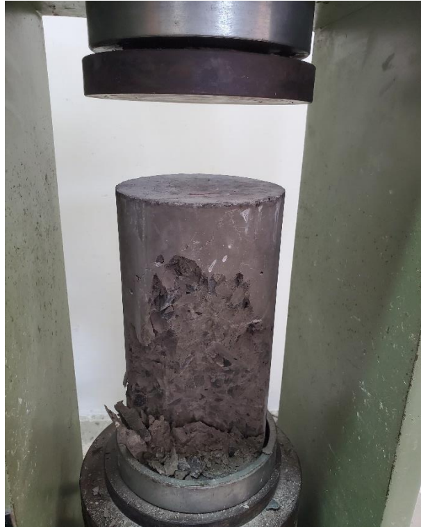
Ensayo de resistencia a la compresión de cada uno de los diseños del tema de estudio modelo patrón, canto rodado (lastre) de los aluviales del Rio San Pablo (provincia de los Ríos) y rio Zapotal (Provincia Santa Elena).
