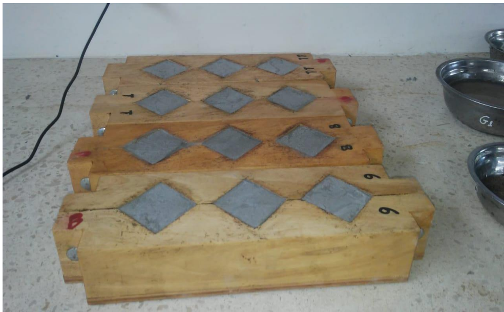
Elaboración de especímenes de morteros de resistencia 20 MPa de canto rodado (lastre) de los aluviales del Rio San Pablo (provincia de los Ríos) y rio Zapotal (Provincia Santa Elena).
