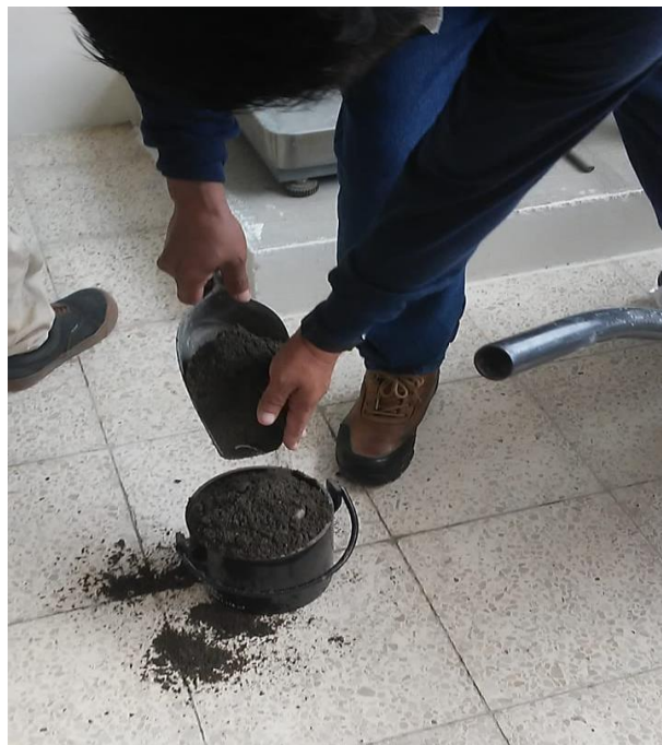
Ensayo del agregado fino (peso volumétrico suelto) de los aluviales del Rio San Pablo (provincia de los Ríos) y rio Zapotal (Provincia Santa Elena)
