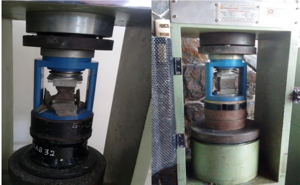
Ensayo de resistencia a la compresión de cada uno de los especímenes de mortero de los diseños de canto rodado (lastre) de los aluviales del Rio San Pablo (provincia de los Ríos) y rio Zapotal (Provincia Santa Elena).
