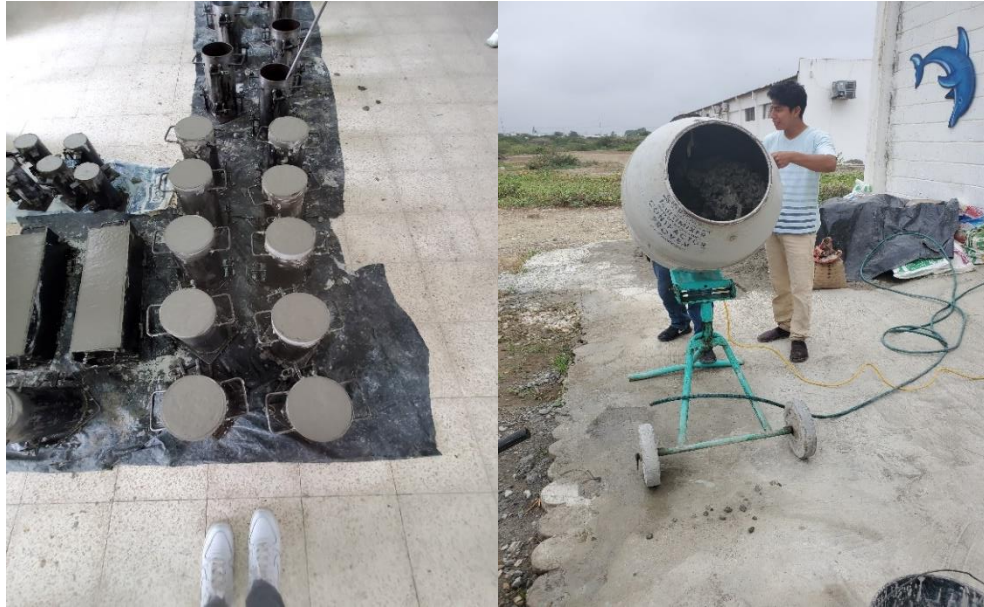
Preparación de mezcla de hormigón para fundir las probetas de resistencia de f'c 240 Kg/cm 2 modelo patrón, canto rodado (lastre) de los aluviales del Rio San Pablo (provincia de los Ríos) y rio Zapotal (Provincia Santa Elena).
