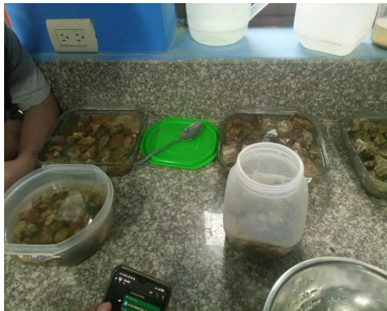
Ensayo de sulfato de magnesio de los materiales de canto rodado (lastre) de los aluviales del Rio San Pablo (provincia de los Ríos) y rio Zapotal (Provincia Santa Elena).
