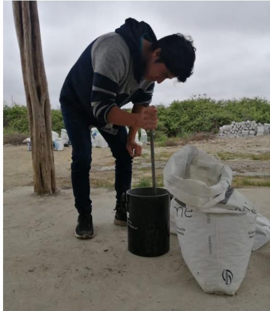
Ensayo de peso volumétrico varillado del canto rodado (lastre) para diseño de dosificación de f'c 240 Kg/cm 2 de los aluviales del Rio San Pablo (provincia de los Ríos) y rio Zapotal (Provincia Santa Elena).
