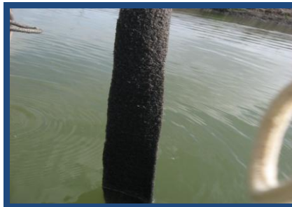
Fig # 2 Geotextil 20 x 100 cm, utilizado como substrato para el perifitón.
