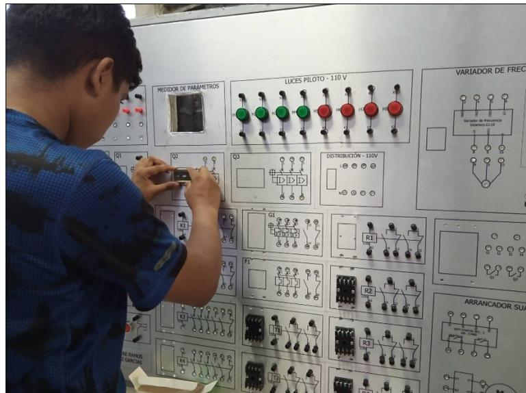
*Figura 40: Instalación de riel din para soporte de equipos.*
