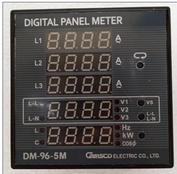
*Figura 23: Medidor de parámetros Camisco DM-96-5M.*
