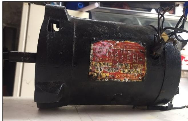
*Figura 27: Motor monofásico Schneider ½ HP.*
