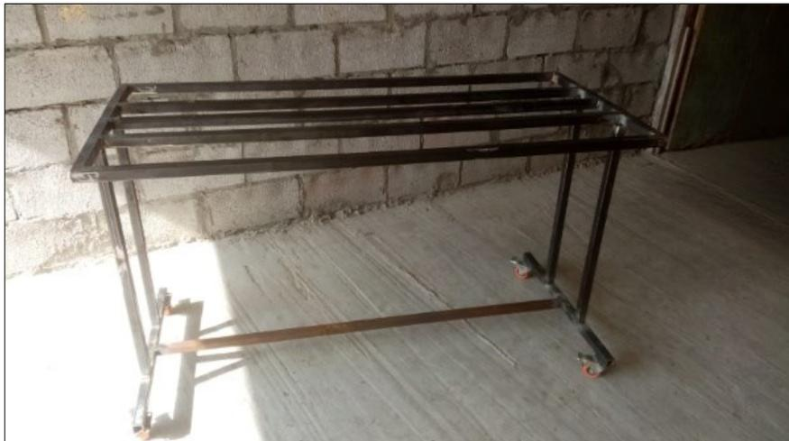
*Figura 29: Estructura base del tablero eléctrico.*
