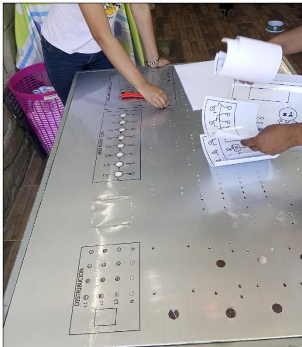
Figura 37: Colocación de las láminas de conexiones.
