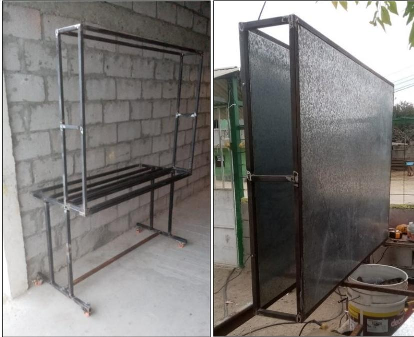
*Figura 30: Estructura principal del tablero.*
