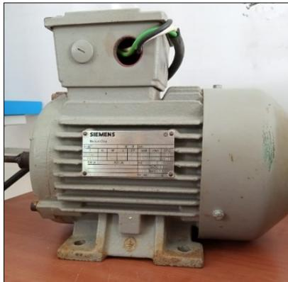
Figura 28: Motor trifásico Siemens 1HP.
