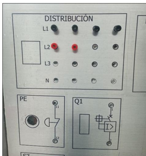
Figura 38: Instalación de borneras de distribución.
