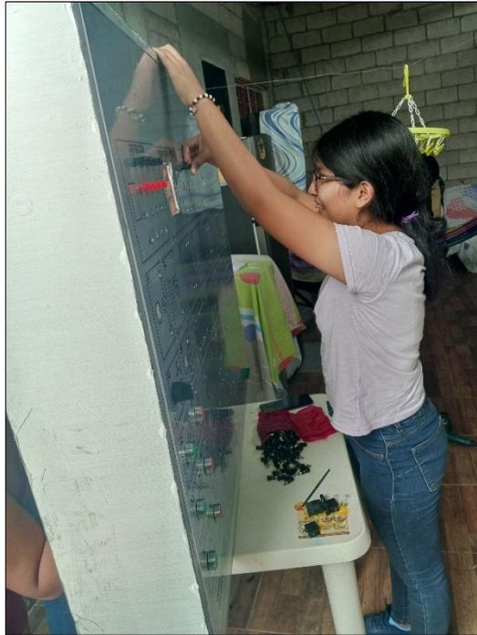
*Figura 39: Colocación de pulsadores y borneras.*
