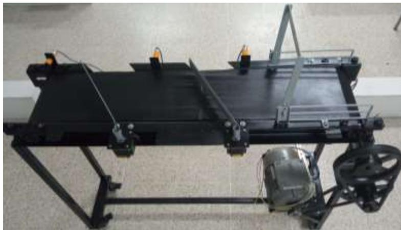
**Figura 18.** Banda transportadora y sistema de clasificación
