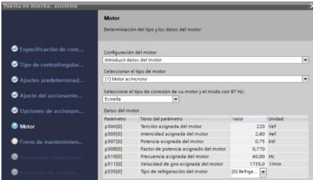
**Figura 55.** Parametrización del motor a controlar desde el TIA Portal
