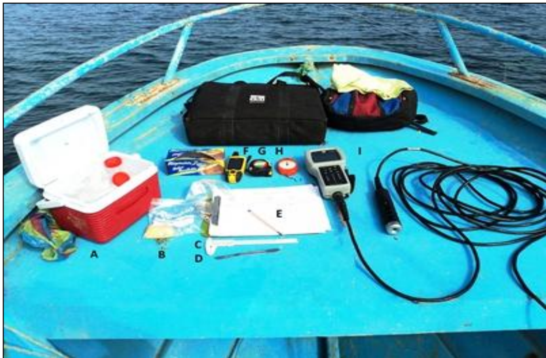
Foto 6: Herramientas de campo. A; hielera. B; fundas de polietileno. C; Ictiometro. D; Bisturí. E; Hoja de registros. F; GPS. G; cinta métrica. H; Pesa manual. I; Indicador de parámetros YSI.
