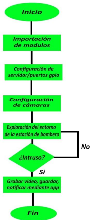
Figura 13: Diagrama de flujo del sistema de vigilancia. Fuente: Propia.
