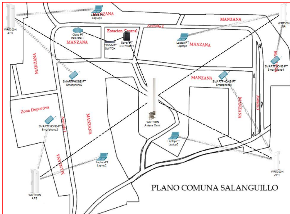
Ilustración 11: Transmisión de señal de Wifi a usuarios.
