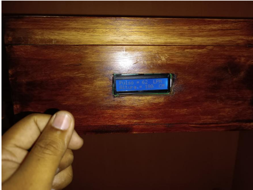
Figura 70. Pantalla led del medidor
