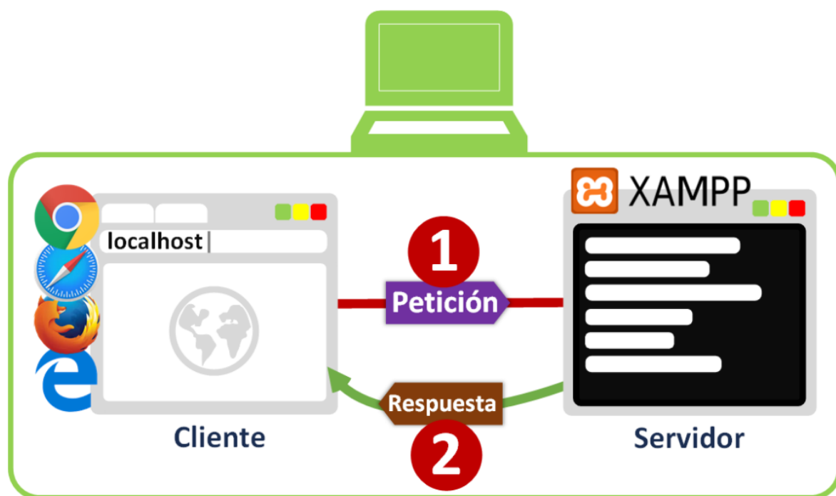
Ilustración 5 Esquema de peticiones HTTP Cliente/Servidor
