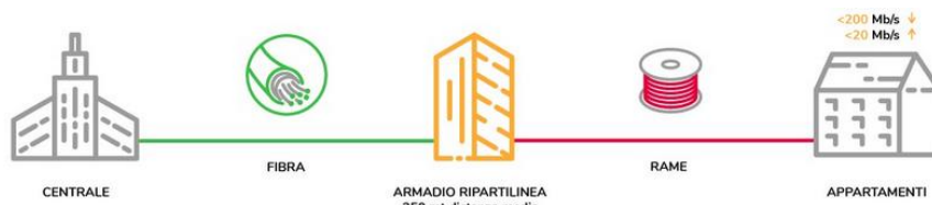
Figura 12.- Arquitectura de fibra hasta la acera. Imagen tomada del sitio web "francescor"
