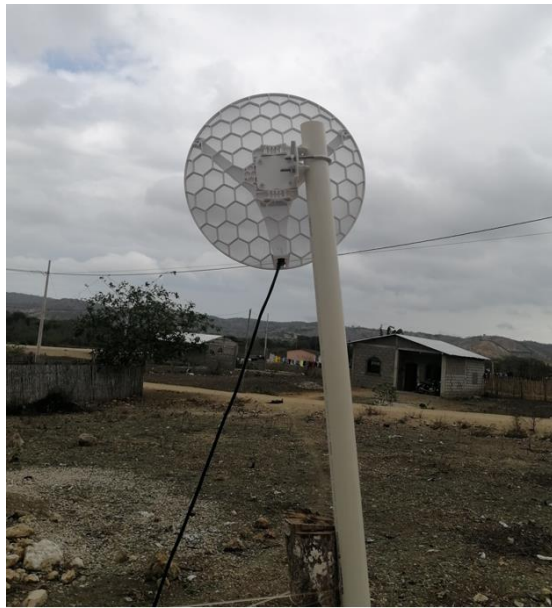
Figura 166.- Antena con localización en el punto de repetición.
