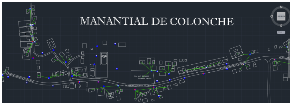
Figura 195.- Red de distribución GPON. Imagen tomada de la ventana de trabajo de Autocad.
