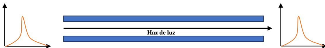
Figura 8.- Propagación del haz de luz en la fibra monomodo. Imagen elaborada por el autor
