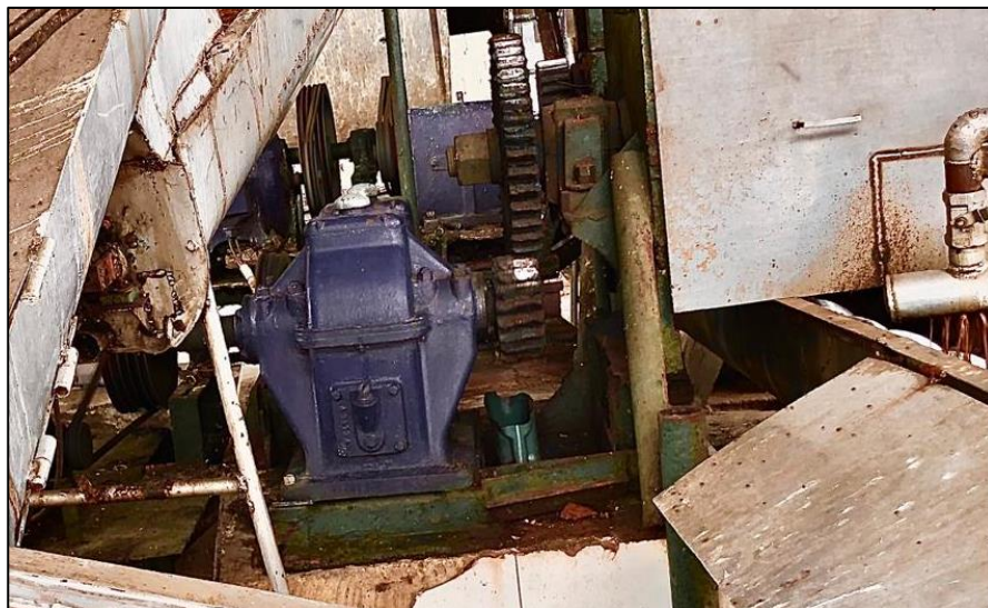
Figura 16. Reductor de velocidad mecánico
