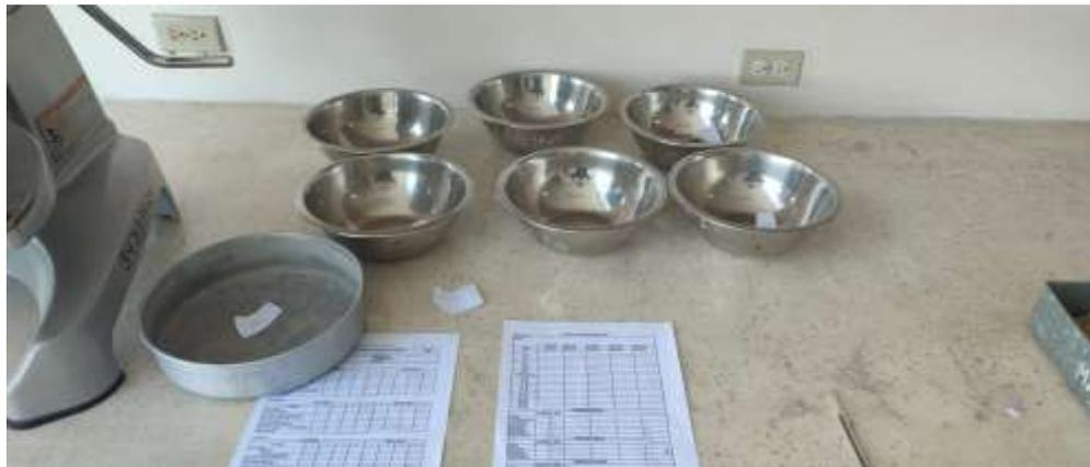
Figura 36 Ensayo de gravedad Específica
