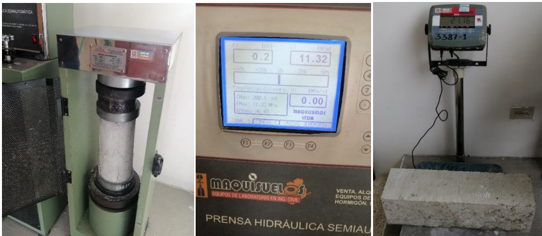
Anexo 7: Ensayo a compresión y flexión de cilindros y viga con el 25% de fibra de caña.
