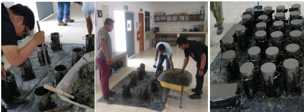
Anexo 5: Ensayo a Compresión del hormigón patrón
