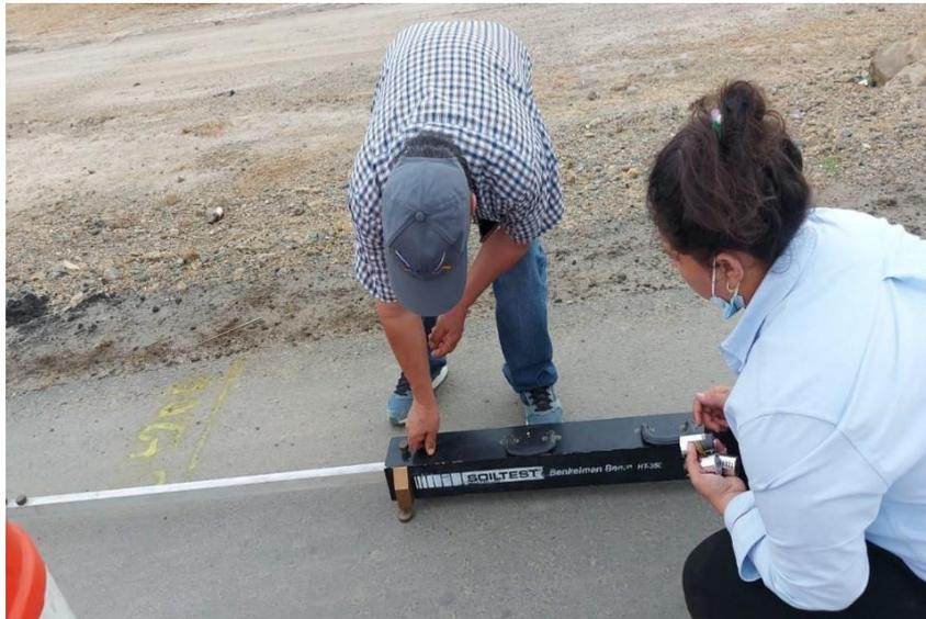
*Nota:* Colocación de pilas en la Viga y ajuste de calibres.
