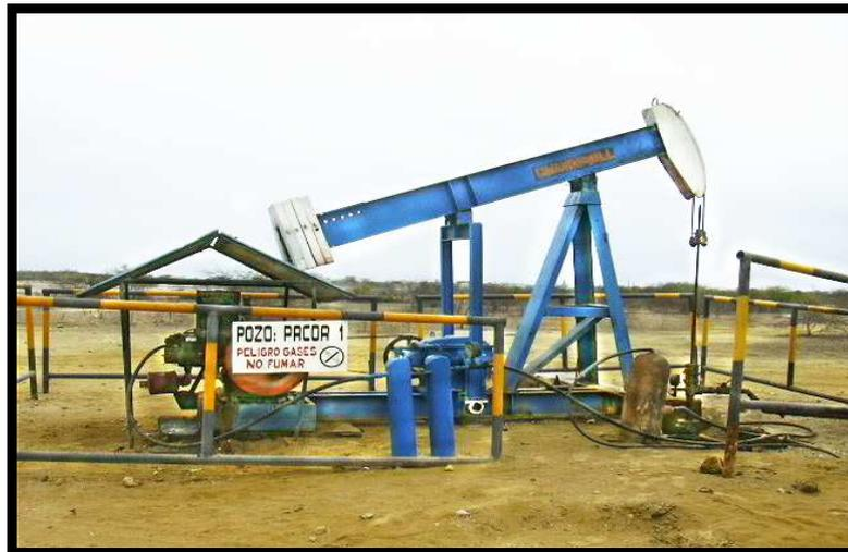
**Figura 1.6** Equipo de bombeo mecánico.
