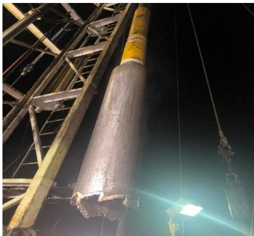
Fig. 37 Operación de limpieza de arena mediante Tubing Bailer.
