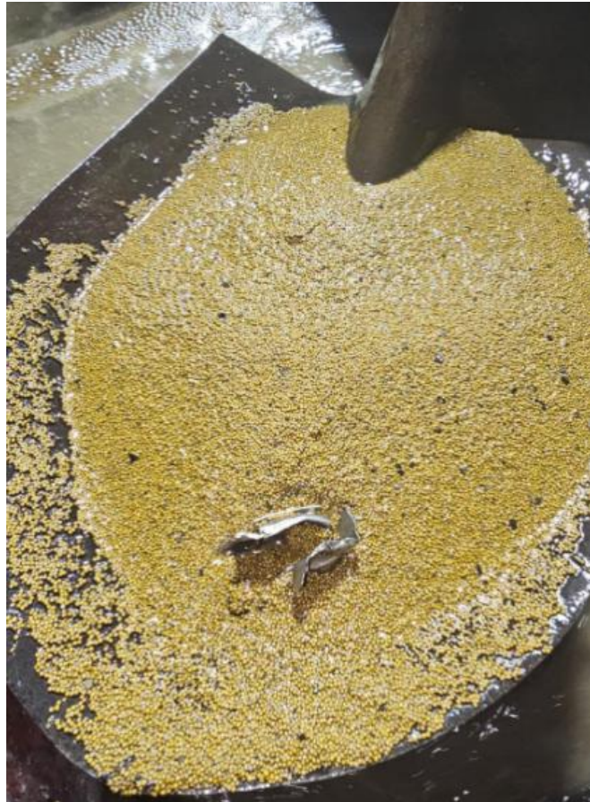
Fig. 42 Operación de limpieza de arena mediante Tubing Bailer.
