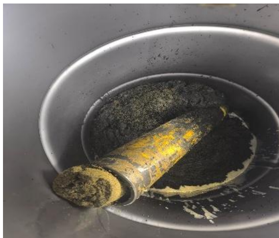
Fig. 35 Operación de limpieza de arena mediante Tubing Bailer.
