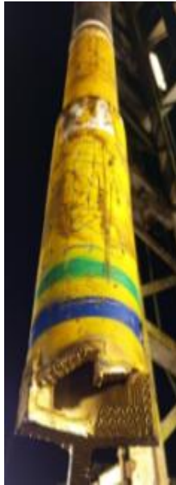
Fig. 38 Operación de limpieza de arena mediante Tubing Bailer.
