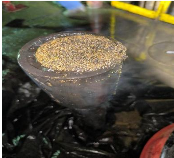
Fig. 34 Operación de limpieza de arena mediante Tubing Bailer.
