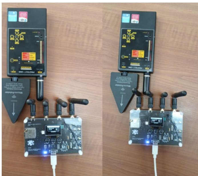
Fig. 42. RF-Clown v2 energizado frente al Protect 1206i
