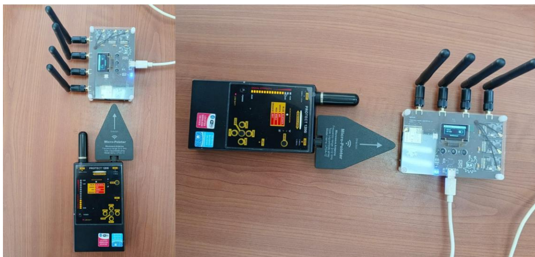
Fig. 40. RF-Clown v2 energizado frente al Protect 1206i
