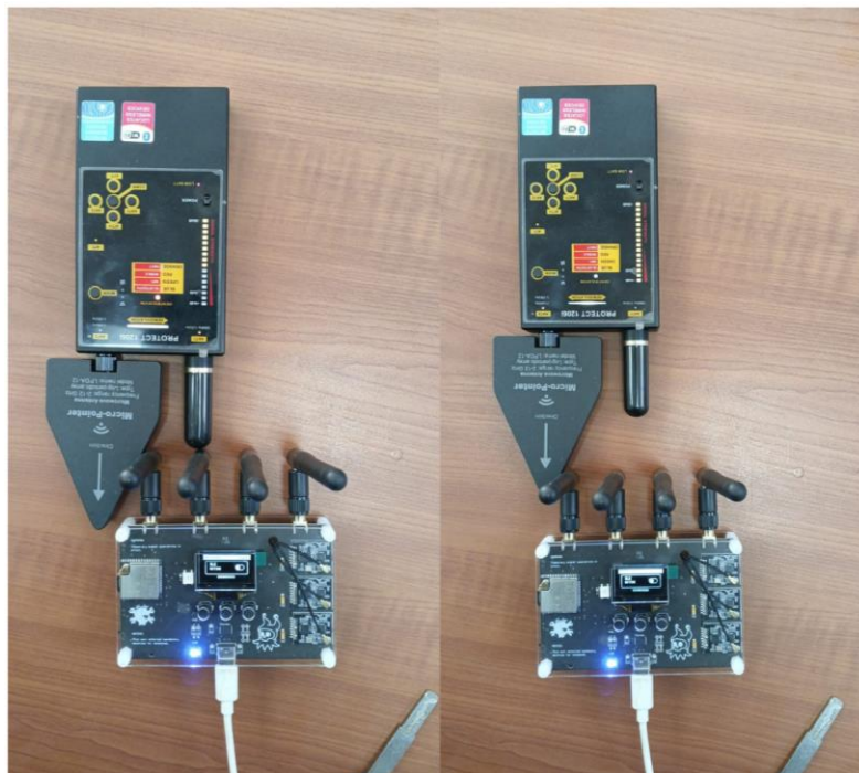
Fig. 44. BLE operando junto al detector Protect 1206i
