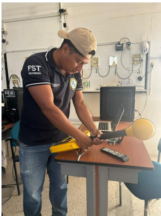
Fig. 59. Colocación de antenas en el Narda
