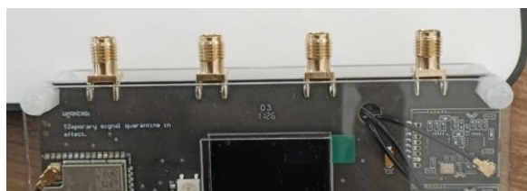
Fig. 24. Ubicación puerto SMA
