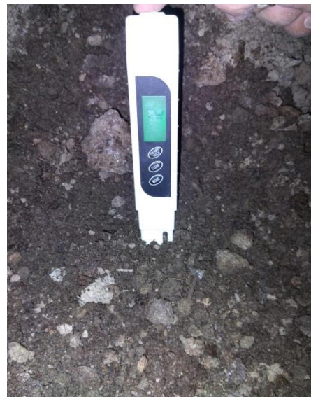
FIGURA A6. Toma de la conductividad eléctrica en compostaje
