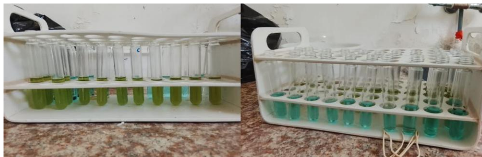
Figura 35 Medición rutinaria de Amonio y Nitrito por colorimetría
