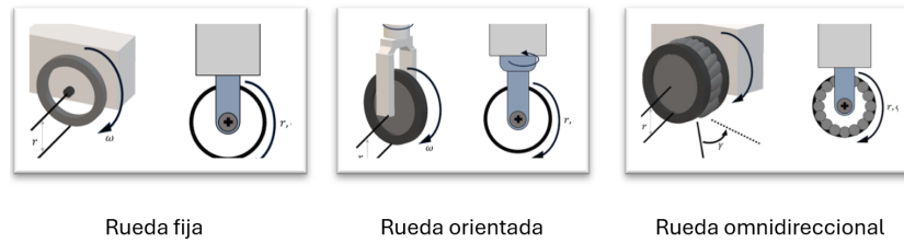
Fig. 11. Clasificación de tipos de ruedas y sistemas de locomoción en robótica móvil. Fuente: [22].
