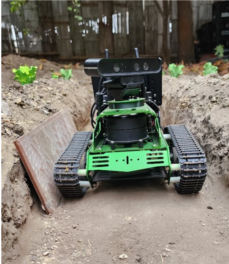
Fig. 22. Vista a nivel del suelo evidenciando la estrechez del surco y el reto de navegación autónoma. Fuente: Autoría propia.
