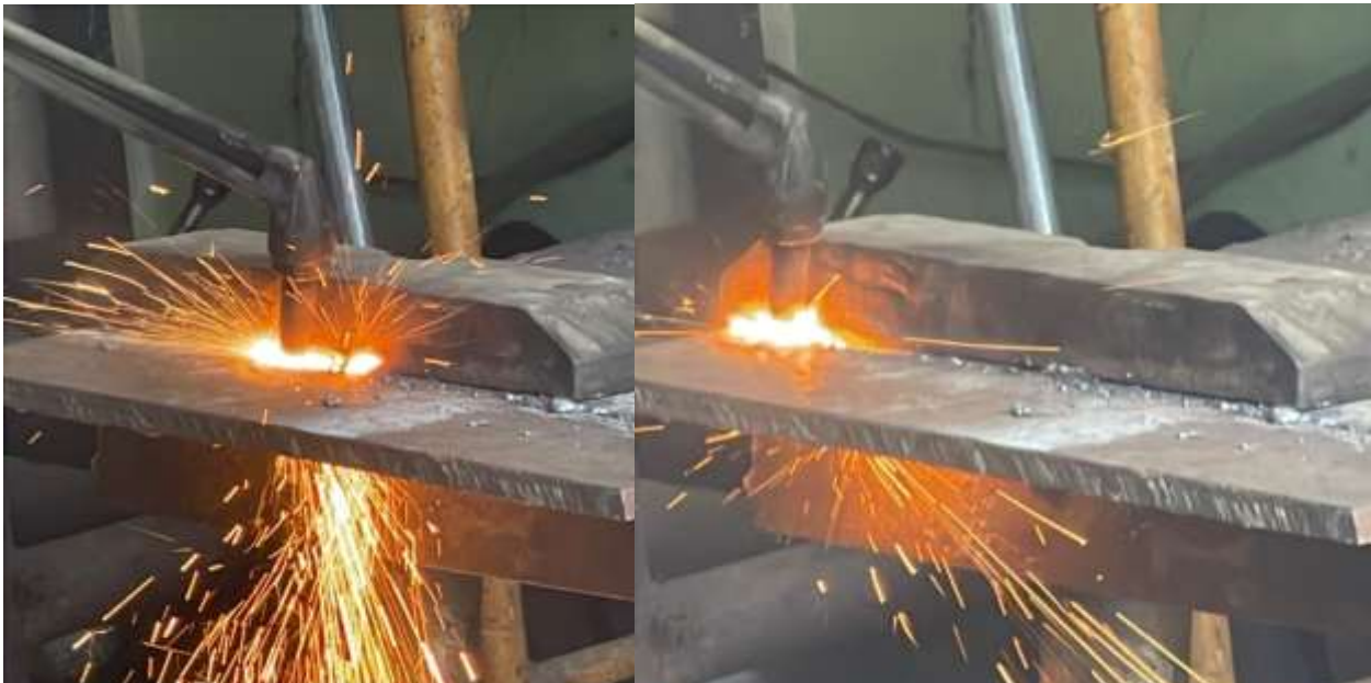
Corte Oxicorte de placas de acero inoxidable de 14 mm para la base superior e inferior con dimensiones de 300mm x 200 mm y placas móviles superior e inferior con dimensiones de 260mm x 100 mm.
