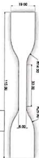
PROBETA TIPO IV – NORMA ASTM D638-14
