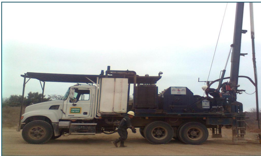
Fig.7 Sistema de levantamiento artificial por Pistoneo o Swab. Fuente: Pacifpetrol.
