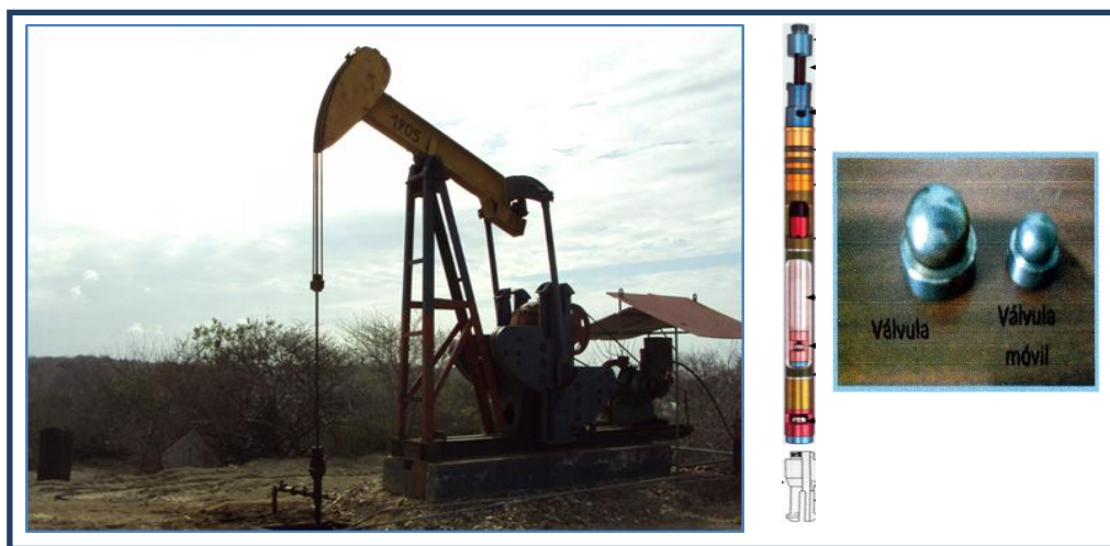
Fig. 8 Sistema de levantamiento artificial por Bombeo Mecánico. Fuente: Pacifpetrol.
