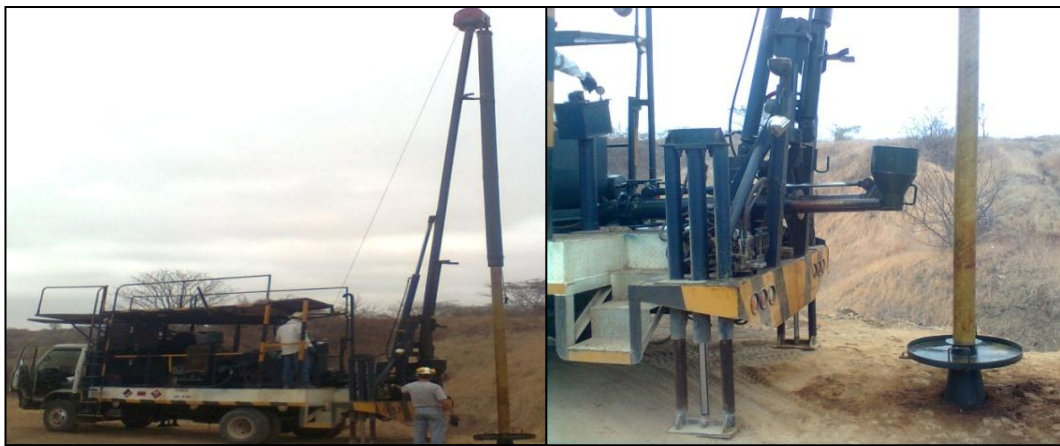
Fig. 6 Sistema de levantamiento artificial por Herramienta Local. Fuente: Pacifpetrol.
