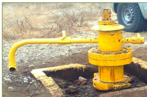
Fig. 17 Tipo de cabezal apto para Bombeo Mecánico y captación de gas.
