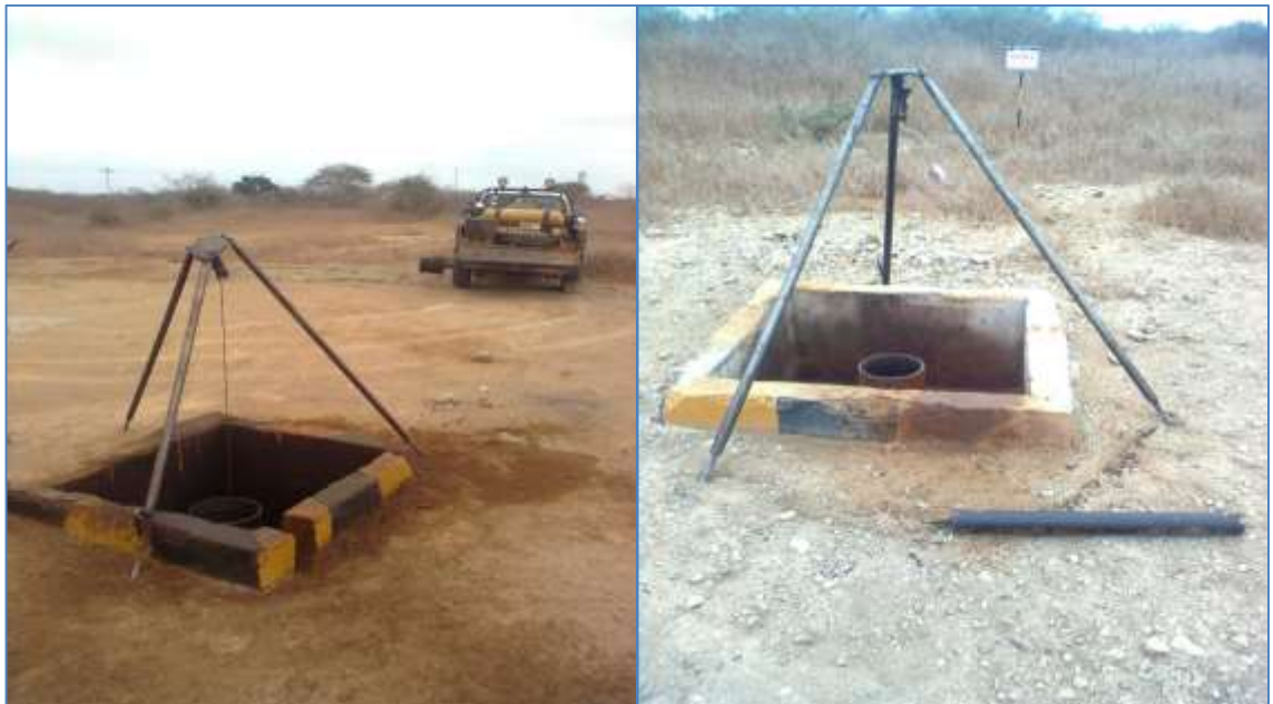
Fig. # 20: Equipo de Wire Line Fuente: Pacifpetrol S.A.
