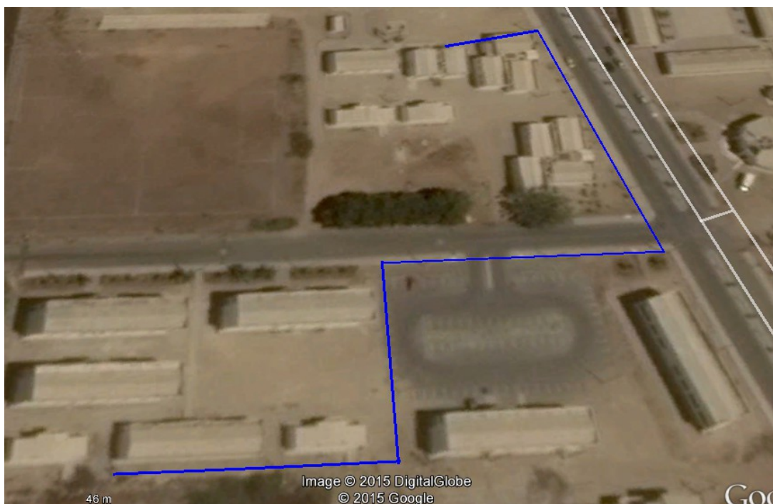
Ilustración 14: Recorrido de la FO ADSS
