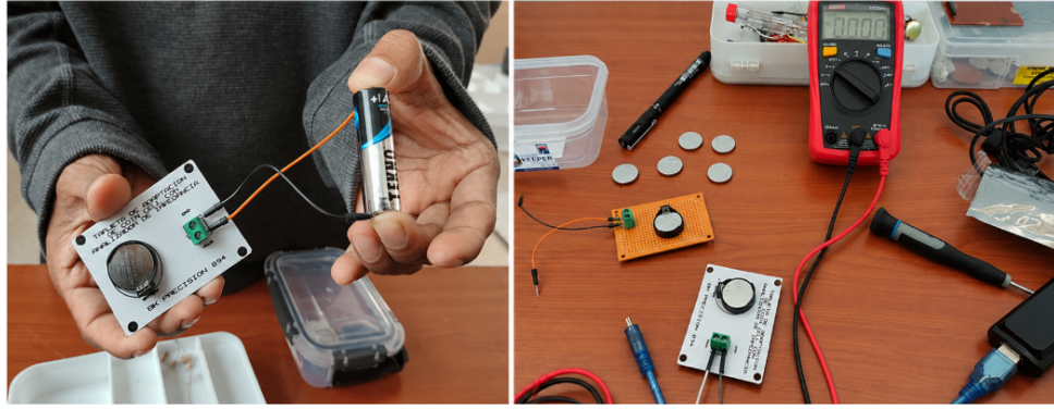
Figure 5: Adaptador para celda tipo botón ( coin cell ) CR2032 destinado a la conexión eléctrica con los instrumentos de medición.
