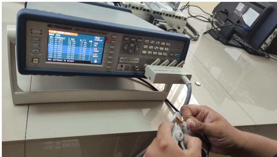
Figure 33: Conexión física de las celdas de prueba utilizando cables tipo Kelvin Clip acoplados al medidor LCR.
