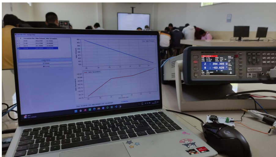
Figure 34: Banco de pruebas integrado con el software en Python y el medidor LCR para la adquisición de impedancia en coin-cells.
