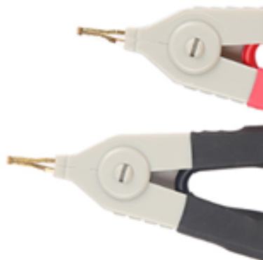
Figure 4: Conectores kelvin clip utilizados para la medición electroquímica.
