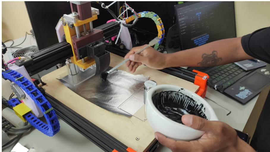
Figure 31: Preparación y colocación manual preliminar de la lechada (*slurry*) sobre la mesa de trabajo de la CNC.
