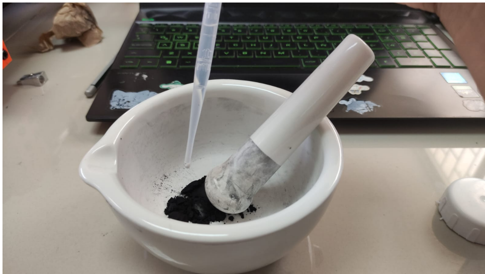
Figure 7: Ajuste de viscosidad de la pasta de carbón activado en el mortero de laboratorio.
