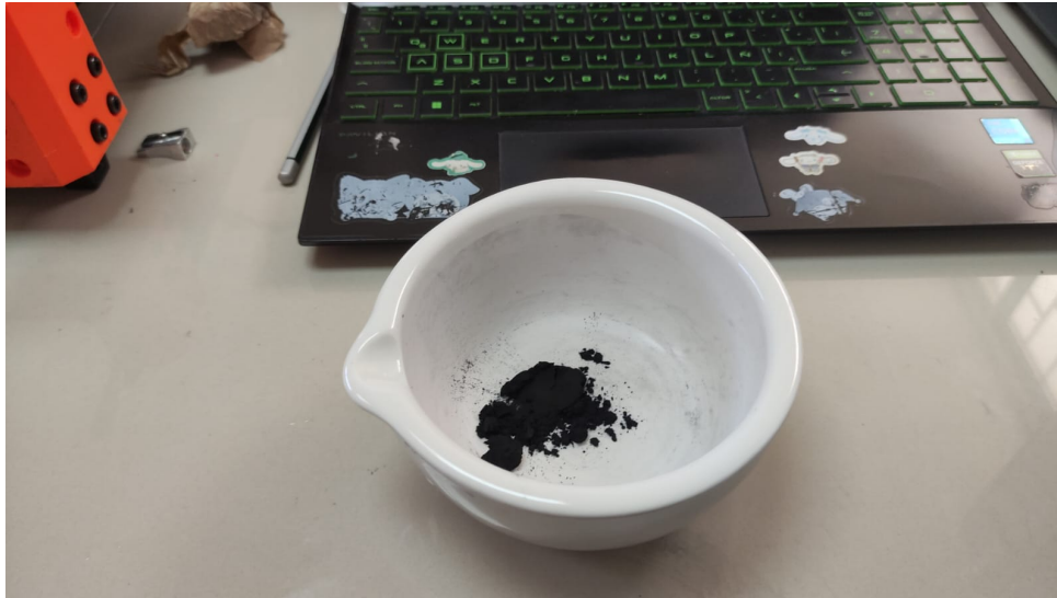
Figure 6: Incorporación y mezcla del carbón activado en el aglutinante ( binder ).
