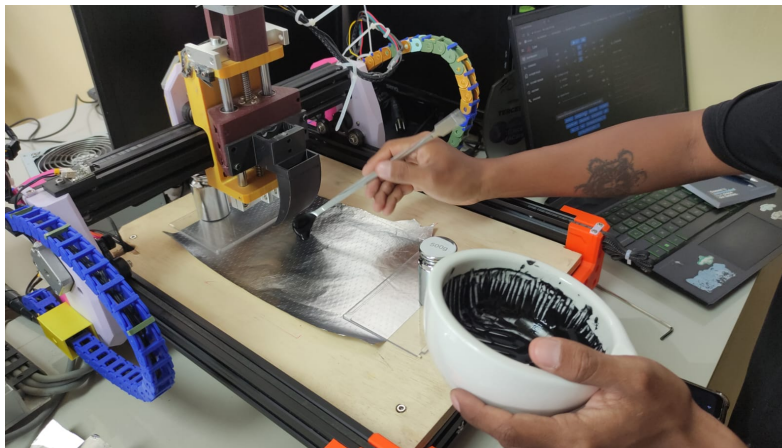
Figure 9: Colocación de la lámina de aluminio sobre la máquina CNC y disposición de la suspensión para el extendido.
