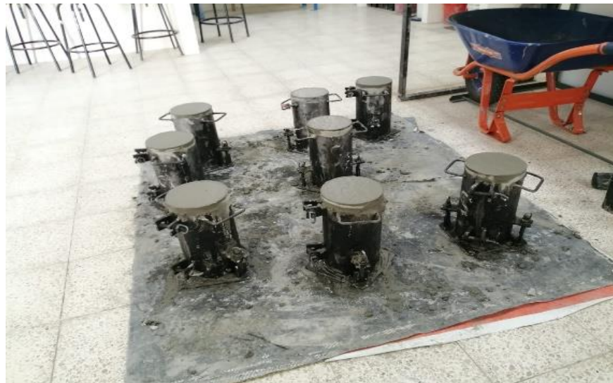
Elaboración de cilindros de concreto
