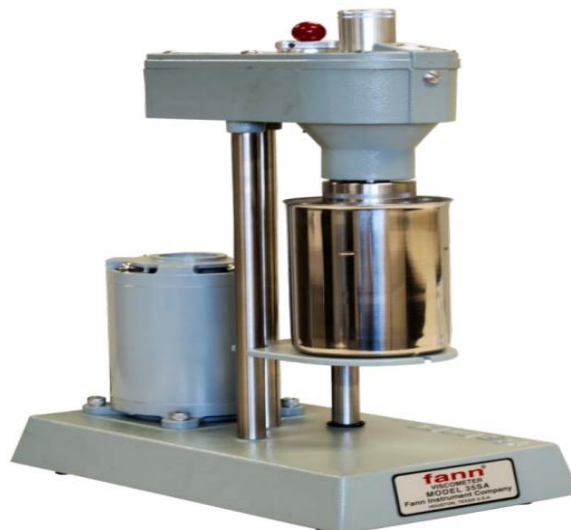
Figura 1. Viscosímetro rotacional Fann modelo 35 A usado para realizar ensayos reológicos Fuente: Adaptado de (Fann , 2016)
