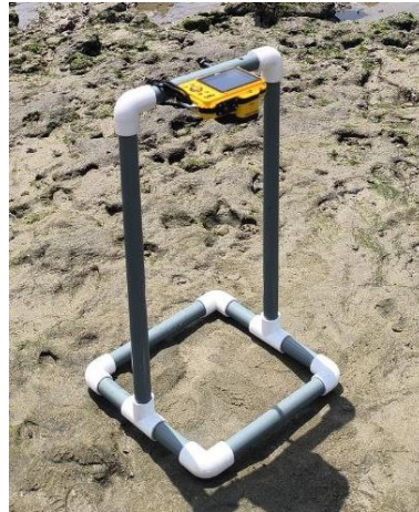
Figura 4: Estructura de fotocuadrante por: Cercado Jannio (2025).
