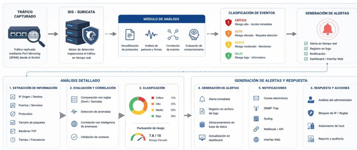
Figura 25: Modelo funcional de análisis, clasificación y generación de alertas del IDS
