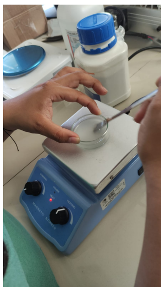
Figura 6: Incorporación de glicerol tras el corte térmico e integración en la matriz.
