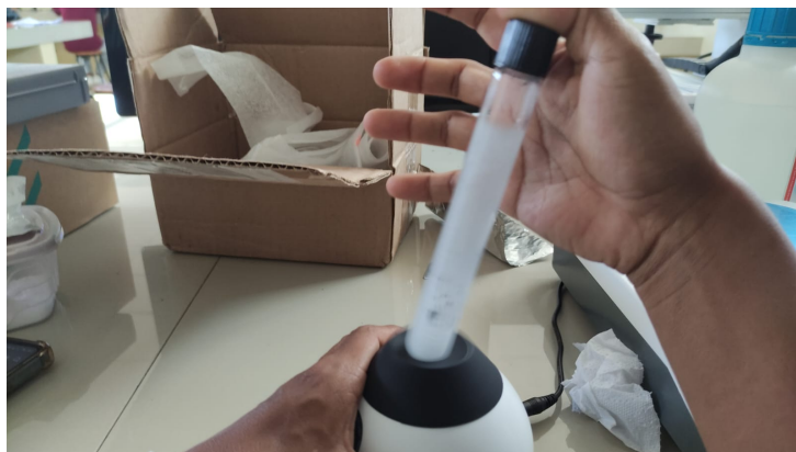
Figura 4: Dispersión inicial del almidón en mezclador de vórtice y traslado a cápsula de Petri.
