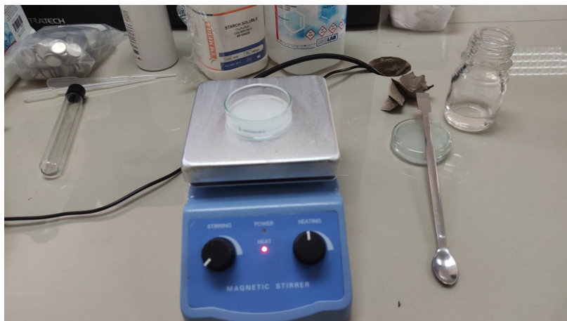
Figura 26: Vertido de los solutos junto con los solventes en cápsula de Petri sobre el agitador magnético para el inicio de la gelatinización.
