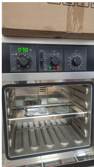
Figura 7: Estabilización y curado térmico del gel electrolítico en horno a 70 °C.
