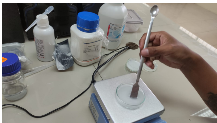
Figura 5: Adición del soluto iónico y gelatinización térmica sobre el agitador magnético.
