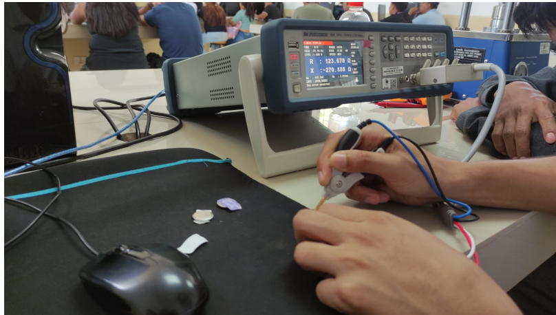
Figura 31: Caracterización electroquímica directa de las celdas mediante el medidor LCR BK Precision 894 con pinzas Kelvin.
