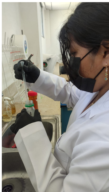
Figura 29: Adición y dosificación de glicerol como agente plastificante para la matriz polimérica.
