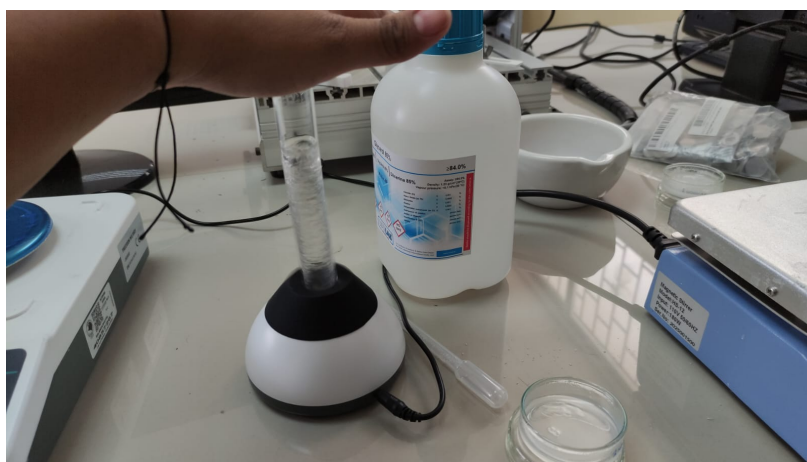
Figura 25: Proceso de agitación energética y homogeneización de la mezcla precursora utilizando el agitador tipo vórtice (modelo VM200).
