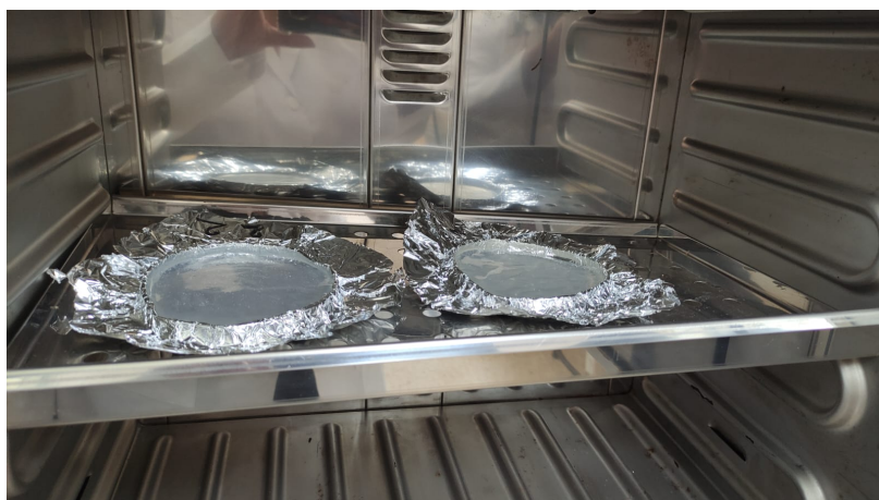
Figura 27: Proceso de curado y estabilización térmica de las películas de hidrogel en el horno de secado Memmert UN 55.
