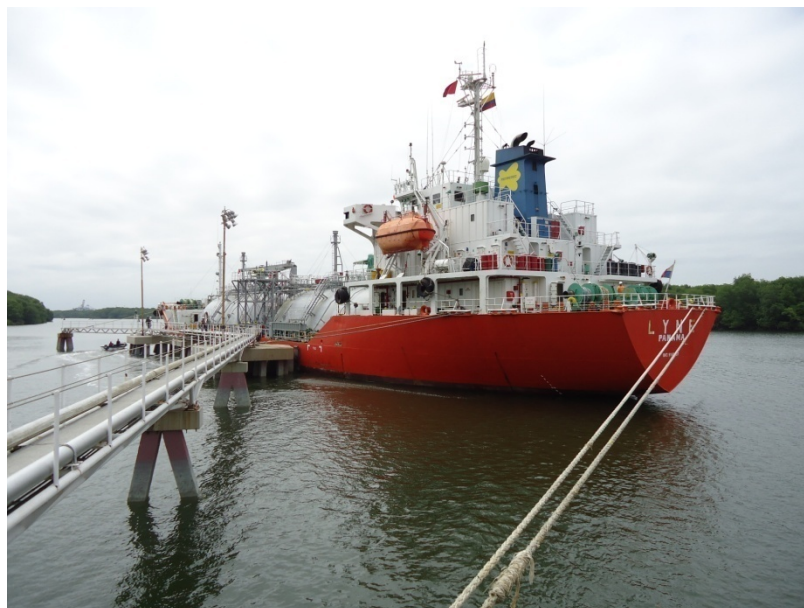
Fotografía 19: Acoderamiento y amarre seguro del B/G con carga GLP
