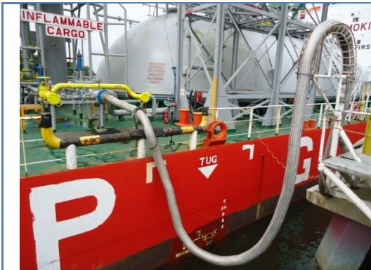
Fotografía 26: Conexión de manguera del B/G contenedor de GLP
