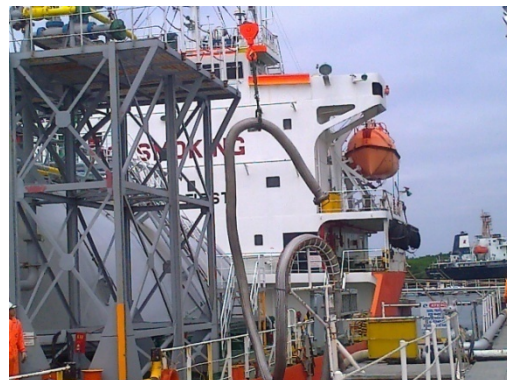
Fotografía 21: Grúa levantando la manguera de acero inoxidable
