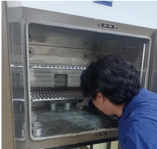
Figura 19 Secado de muestras de suelo en laboratorio a 105°C
