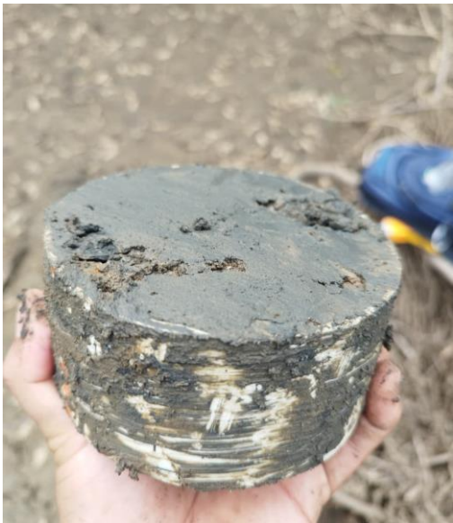
Anexo 3 Muestra de suelo para análisis en laboratorio (DA, Fh)
